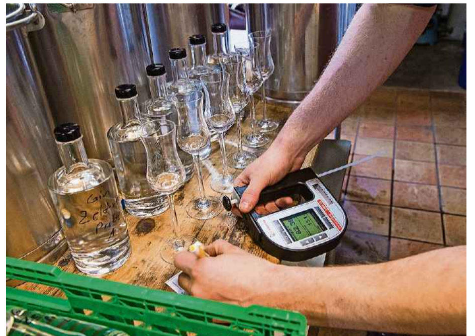
Der Brenner misst jeweils den Alkoholgehalt der Spirituosen.
